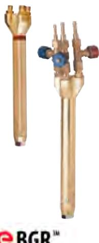
Arzatorul poate fi folosit pentru toate tipurile de gaze datorita sistemului prin care amestecul se face in duza. La acest tip de arzator prinderea si etansarea duzelor se face printr-un sistem conic cu inclinatia de 30°. Aspectul exterior al arzatorului este similar cu cel al arzatorului BIR fiind robust si sigur.
