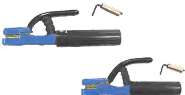
Portelectrozii CROCODIL au un maner striat oferind o priza ferma, si un bun echilibru. Arcul este protejat pentru a preveni deteriorarea din cauza stropilor, si fixarea cablului se face cu ajutorul unui surub si al unui inel de cupru (in dotare). Unii dintre cei mai populari portelectrozii de pe piata, acestia sunt folositi pentru regim intensiv de lucru. Clasa de izolatie B
