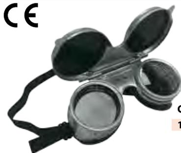
Ochelarii VISUAL FLIP METAL au o rama din aluminiu foarte rezistenta cu margini de cauciuc moale si prevazuti cu aerisiri laterale. Lentilele sunt din sticla si pot fi inlocuite. Dispozitivul flip-up permite schimbarea rapida a lentilelor pentru diferite aplicatii.
