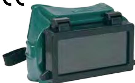
VISUAL SQUARE sunt ochelari/masca potriviti pentru multiple operatiuni prevazuti cu 4 aerisiri pentru a preveni incetosarea si arie vizuala dreptunghiulara 50 × 105mm. Rama din nylon moale cu banda elastica de cap este complet reglabila pentru orice fel de conformatie. Dispozitivul flip-up permite schimbarea rapida intre lentile clare si intunecate. Lentilele sunt inlocuibile
