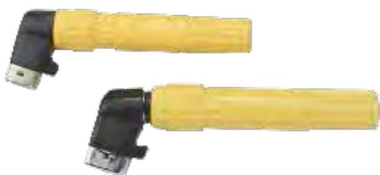
Portelectrozii TWIST sunt complet protejati in partea frontala. Electrocul se pozitioneaza la 90° si se blocheaza rotind manerul. In timpul utilizarii, electrocul este ferit complet fata de exterior, reducand riscul de scurtcircuit. Potrivit in special pentru sudarea in plan vertical. Clasa de izolatie B
