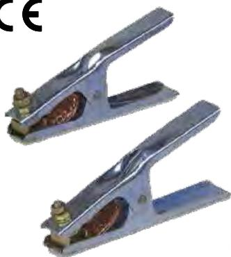
Cleme de masa destinate pentru utilizare semi-profesionala, pentru utilizare generala, cu aparate de sudura mici (transformatoare sau mici invertoare pana la 150A). Fixarea cablului direct la punctul de contact.
