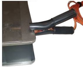
Fig. 48: Brățara piesei de prelucrat conectată la masa de sudură conductoare de electricitate
