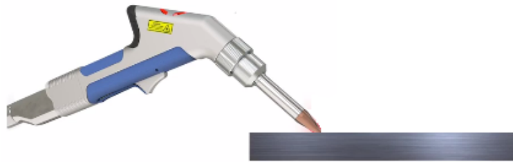
Fig. 47: Unghiul adecvat pentru a ține capul de sudură atunci când se poziționează duza pe piesă
