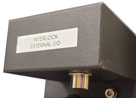
Fig. 24: conector I/O extern de blocare cu 12 pini M12 femelă, orientare A
