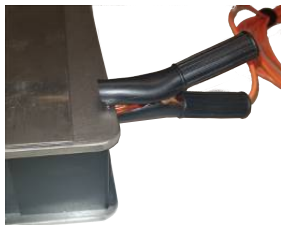
Fig. 46: Brățara piesei de prelucrat conectată la masa de sudură conductoare de electricitate
